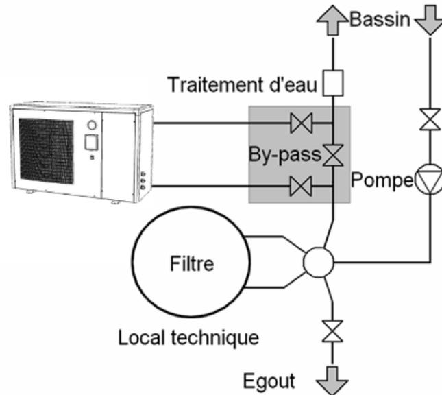
Si votre installation est équipée avec un traitement avec adduction de produits (chlore, brome, sel, ...) le by-pass doit être installé avant le traitement de l'eau avec un clapet anti-retour entre le by-pass et le traitement d'eau.
