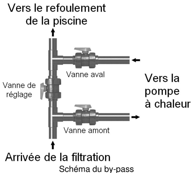
Une fois l'appareil relié au circuit d'eau avec le by-pass, et relié au circuit électrique par un professionnel, s'assurer que :
